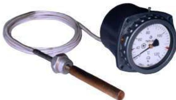
Предназначен для непрерывного измерения температуры воды, масла и других жидкостей, неагрессивных к материалам термобаллона (латунь ЛС59-1 или сталь 12Х18Н10Т), и управления внешними электрическими цепями нагревательных элементов или установок. Относятся к ГСП.
