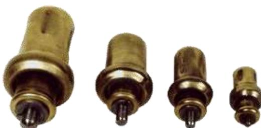
Применяются в качестве первичных измерительных преобразователей изменения температуры в перемещение (ход) штока в регуляторах температуры прямого действия, термодатчиках, термореле.
