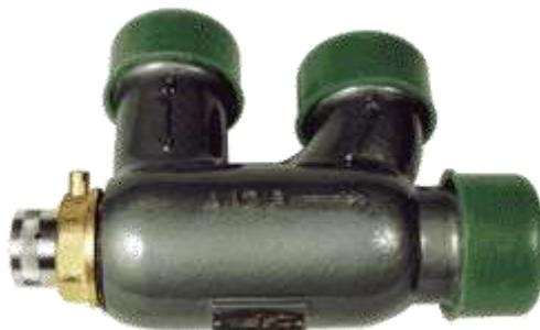
Терморегулятор прямого действия не дистанционный, предназначен для автоматического регулирования температуры масла в системе смазки дизелей типа М3, М4, М7.
