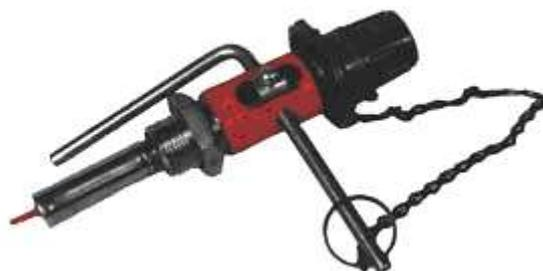
Предназначен для регулирования притока воздуха в топочное пространство твёрдотопливных отопительных водогрейных котлов мощностью до 30 кВт с целью поддержания температуры воды на выходе на уровне, задаваемом вручную, по шкале регулятора.
