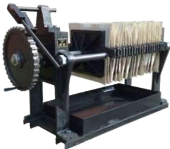
Предназначен для фильтрации под избыточным давлением нейтральных, щелочных или кислых суспензий, содержащих до 500 кг/м<sup>3</sup> твердых частиц, с возможностью промывки и продувки осадка. Применяется на станциях для нейтрализации и очистки промышленных стоков.
